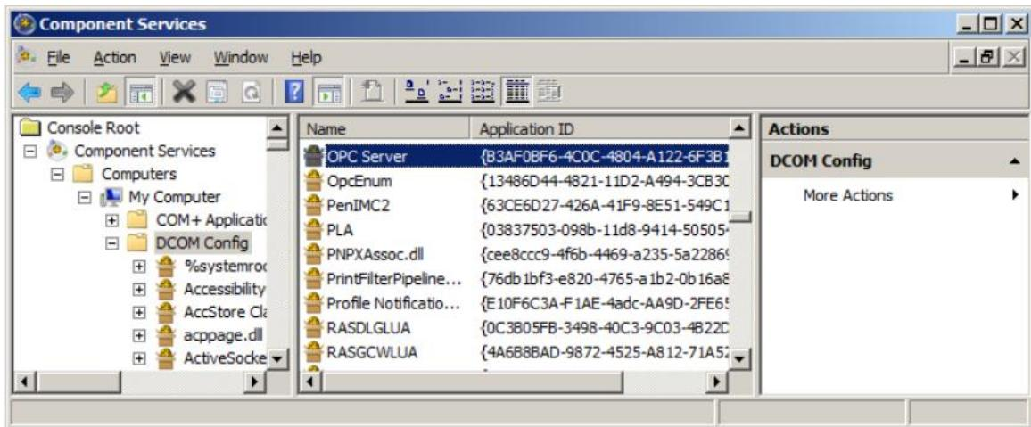
Gelen listeden OPC Sunucunuza tespit edin. Örnek olarak yukarıdaki resimde "OPC Server" gösterilmiştir. Uygulamayı sağ tıklayın ve Properties'i seçin. Açılan pencerede General sekmesinde Authentication Level'i None yapın.
