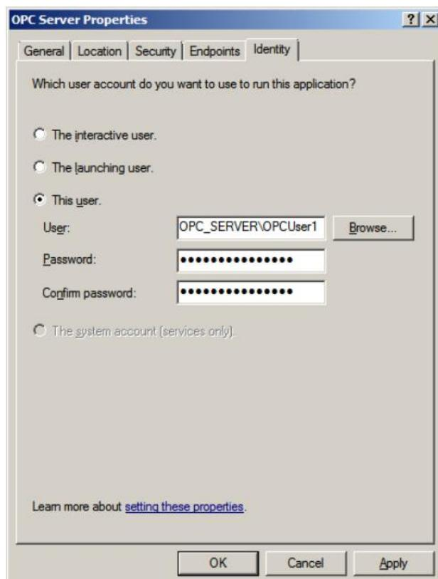
Yapılardırma işlemi için Component Services bileşenini çalıştırın. Bileşene Çalıştır'a dcomcnfg yazarak ulaşabilirsiniz. Console Root, Component Services, Computers, My Computer sekmelerini genişleterek DCOM Config klasörünü bulun. Bu klasör içerisinde DCOM yapılandırması yapılacak OPC Sunucu ya da İstemci uygulamaları bulun. Sağ tıklayarak Properties menüsünü açın. Identity sekmesinde This user seçeneğini ve DCOM ayarları yapılandırılmış olan kullanıcının bilgilerini giriniz.
