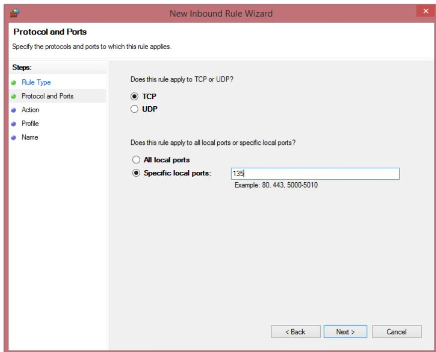
Daha sonra Protocol and Ports kısmında TCP'yi seçin ve Specific local ports kısmına 135 giriniz. Action adımında Allow the connection seçimiyle ilerleyip, Profile adımında bağlantının sağlandığı ağın bulunduğu profili ya da tüm profilleri seçerek en son adımda bu kural için bir isim vererek 135 Portu için izin işlemlerini sonlandırın.
