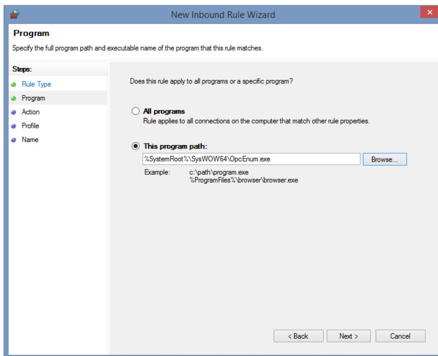
Daha sonra program yolunu olarak C:\Windows\System32\ veya C:\Windows\SysWOW64\ klasörü altında bulunan **OPCEnum.exe** programını seçin. Action adımında **Allow the connection** seçimiyle ilerleyip, Profile adımında bağlantının sağlandığı ağın bulunduğu profili ya da tüm profilleri seçerek en son adımda bu kural için bir isim vererek OPCEnum.exe için izin işlemlerini sonlandırın.
